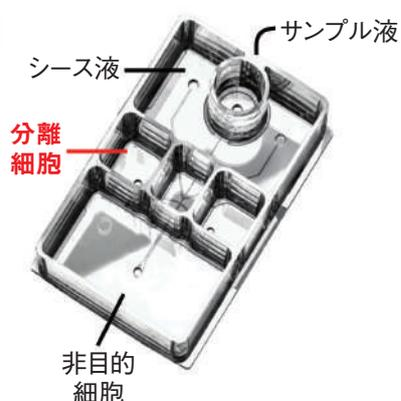
マイクロ流路チップに、サンプルの検出、分離、回収の工程を集約したことで小型化・簡便操作を実現しました。本システムは、細菌から比較的巨大的な細胞塊に加え、ドロップレット(オイル中の微小液滴)など幅広いサンプルの解析に貢献します。
